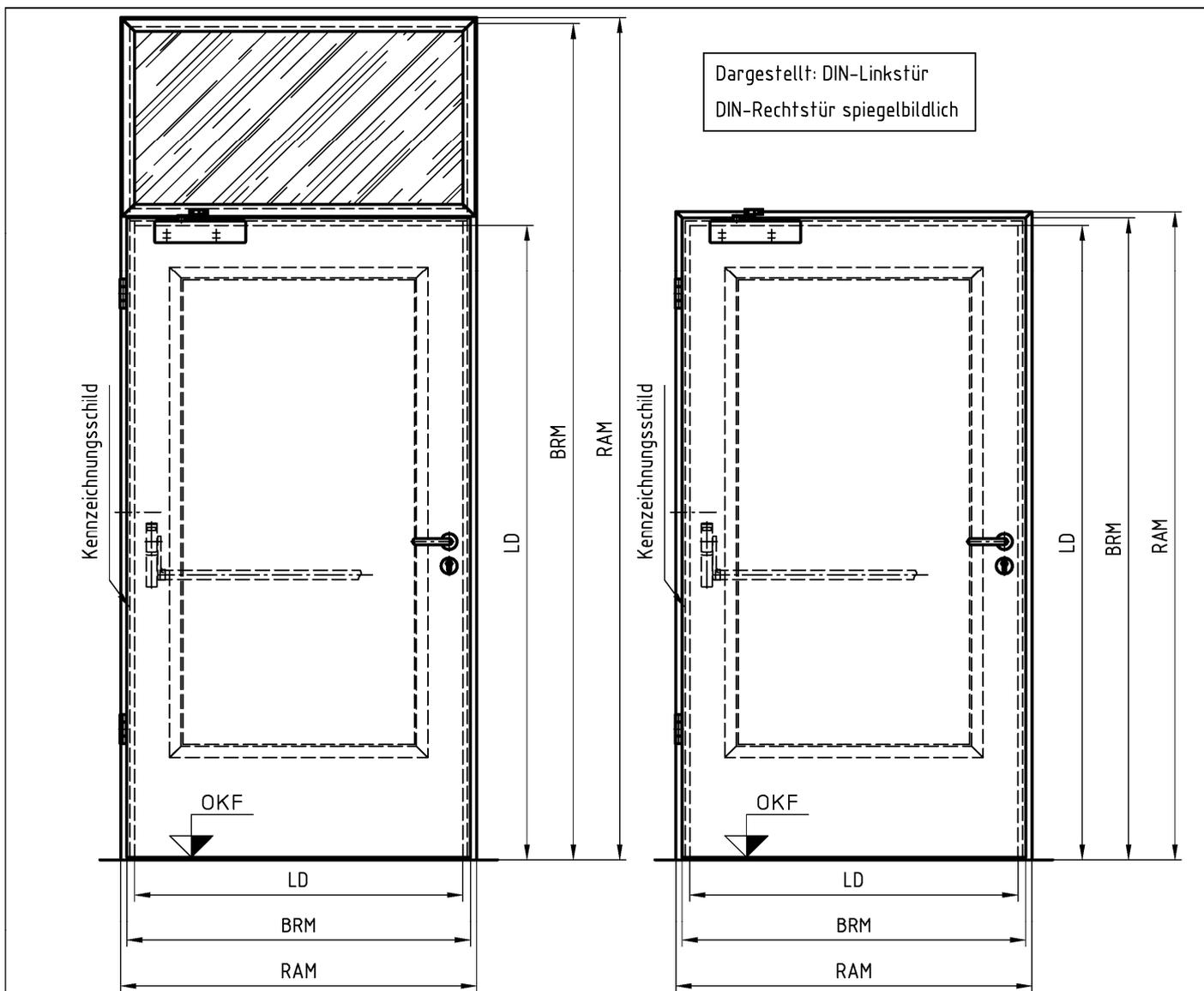
T30-1-RS-Tür immer mit absenkbarer Bodendichtung
