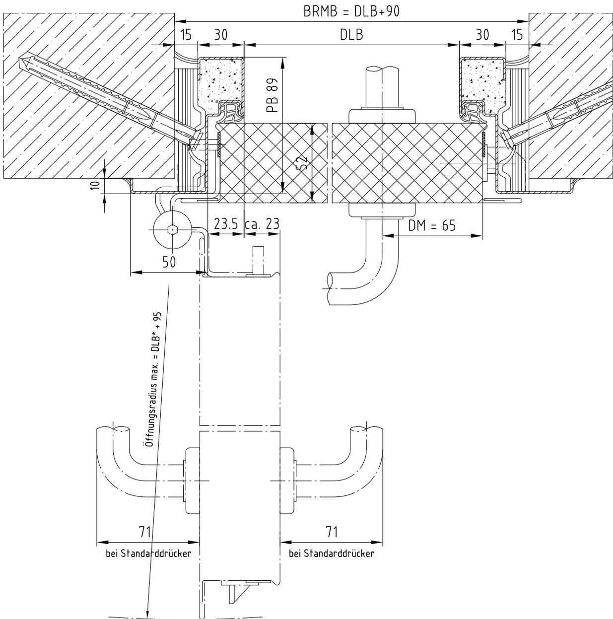
\* ... Durchgangslichte-Breite ohne Berücksichtigung von geöffnetem Türblatt und Anbauteilen wie z.B Drücker, Balken, Türschließer, usw.
