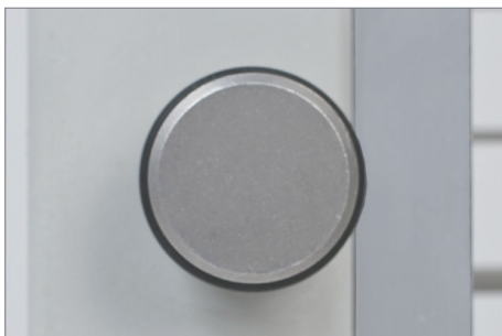
Knopf aufstecken und mit Madenschraube unter dem Gummi auf der Welle sichern
